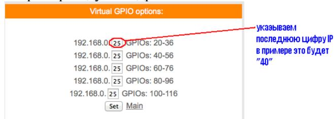
Для управления используется значение “pin=” номер “pin” можно посмотреть на вкладке GPIO того модуля которым будем управлять.
